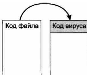
Наложение с сохранением размера инфицированного файла
