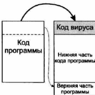
Наложение с сохранением размера инфицированного файла
